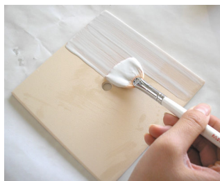
(1) 素焼きタイルに釉薬を塗り乾かします。
